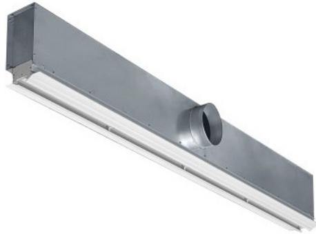
Diffusore lineare a scomparsa con singola feritoia e deflettore cilindrico ruotante, studiato per l'installazione su soffitti in cartongesso per la diffusione dell'aria a soffitto in locali di altezze comprese tra 2,6 e 5,5 m circa, oppure per altezze più elevate a ridosso di parete/vetrata. Grazie alla conformazione del deflettore, i diffusori della serie DFG permettono lanci orizzontali fino a 7 m. Sono disponibili nelle lunghezze da 500 a 2000 mm con incrementi di 100 mm
